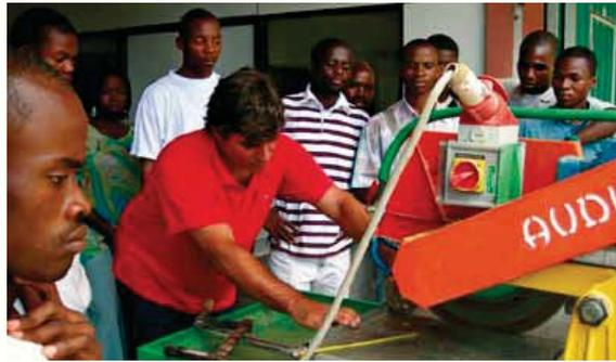
Corte de provetes de betão (Angola) Cursos e assistências técnicas realizados pelo LNEC no âmbito do Programa de Capacitação dos Laboratórios de Engenharia dos
